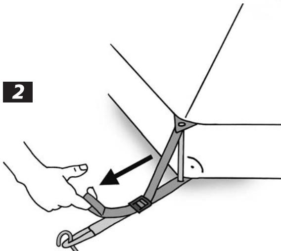
D Zum finalen Abspinnen (1) schließen Sie wieder die Reißverschlüsse des kompletten Zeltzugangs (auch am Moskitonetz) und spannen sie die 5 Bodeneckbänder an den Metallstäbchen straff ab (2).
