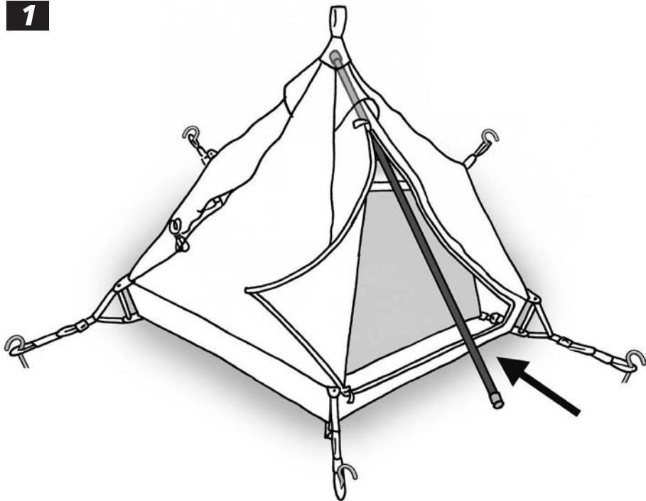
**D** Führen Sie die **Aufstellstange** in das Zelt ein (1) und positionieren Sie das obere Stangenende in die verstärkte Dachspitze (2). Stellen Sie nun das untere Ende der Stange auf die Verstärkung in der Mitte des Zeltbodens (3). Bitte wenden Sie keine Gewalt an, falls Sie die Stange nicht aufstellen können.
